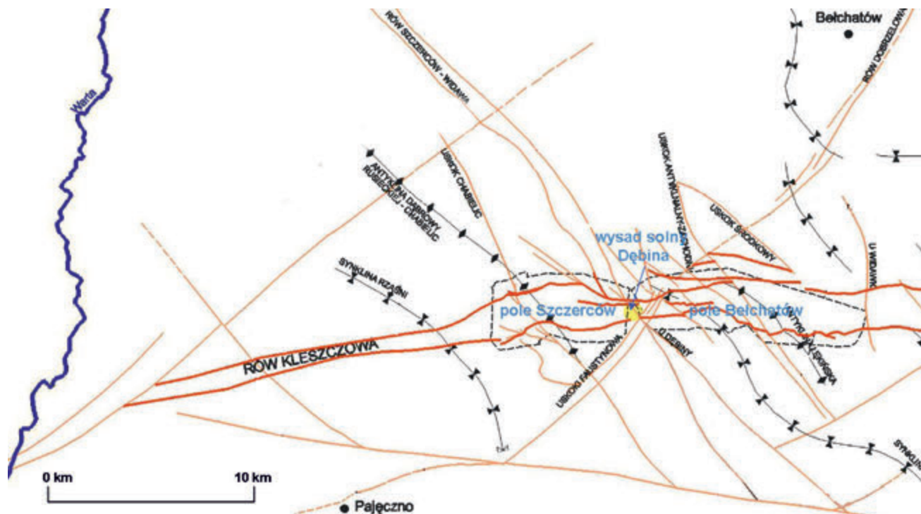
Rys. 1. Przebieg głównych struktur tektonicznych w rejonie złoża węgla brunatnego Belchatów Fig. 1. The course of major tectonic structures in the region of Belchatów lignite deposit
