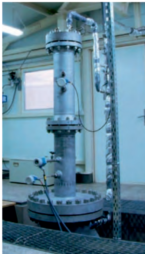
Rys. 1. Modułowy reaktor zgazowania węgla
