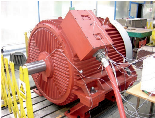
Rys. 7. Widok silnika synchronicznego z magnesami trwałymi o mocy P=1100\text{ kW} na stanowisku badań w DFME DAMEL
