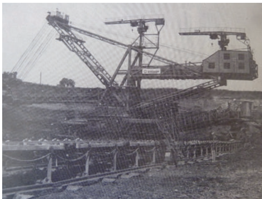
Pierwsza polska duża koparka kołowa KWK 1400 pracująca od 1980 r. w KWB Turów
