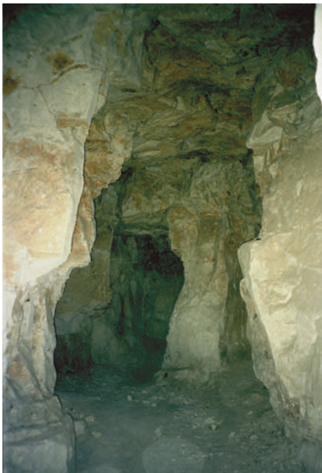
Fot. 5. Komerowa eksploatacja opok w Bochothnicy Fot. 5. The chamber exploitation of opoka in the Bochothnica quarry
