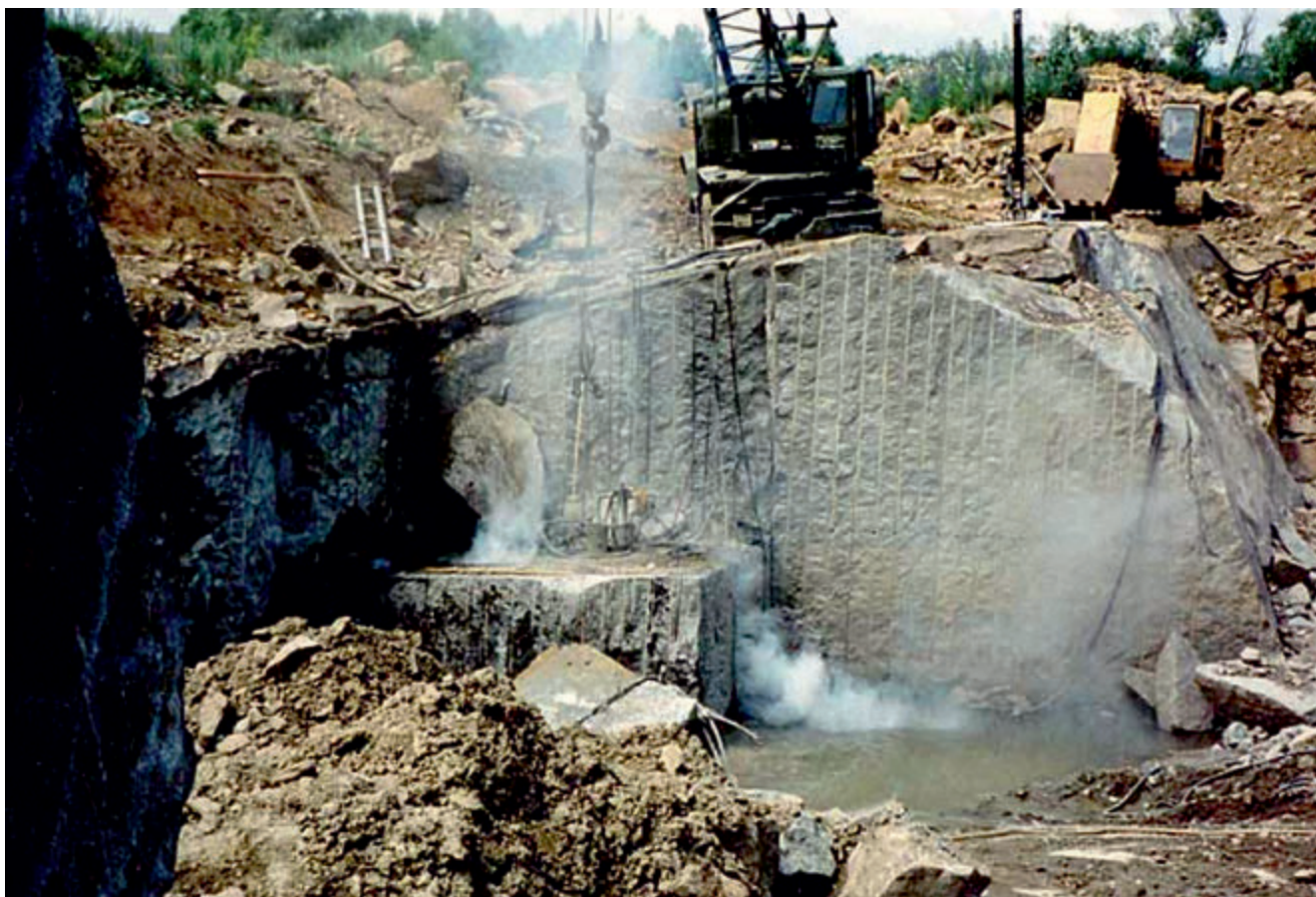
Fot. 5. Moment odpajania monolitu od calizny przy użyciu gazogeneratora Fot. 5. Moment of block separation from rock mass using gasgenerator
