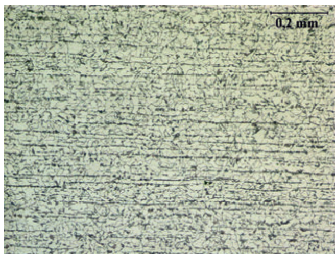
Rys. 3. Mikrostruktura ferrytyczno-perlityczna z wyraźną pasmowością w badanej stali P265GH. Trawiono MilFe
