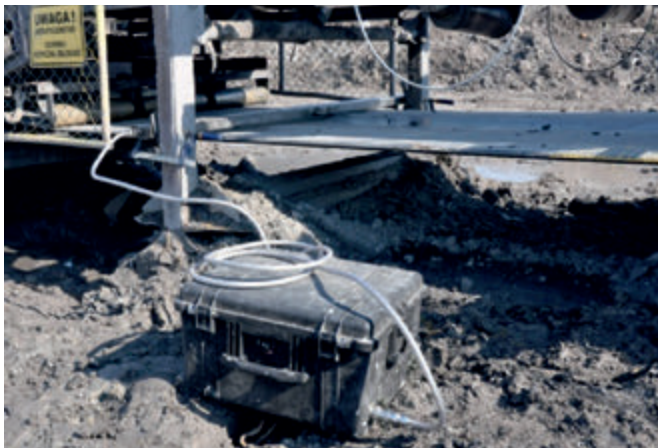
Rys. 2. System pomiarowy w praktycznym działaniu (magnes trwały, listwa pomiarowa, jednostka centralna, notebook z oprogramowaniem w wersji podstawowej)
