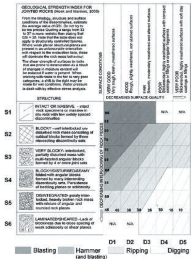
Rys. 3. Propozycja wykorzystania wskaźnika GSI do określenia sposobu urabiania masywu skalnego (PLI > 3 Mpa) [13]
