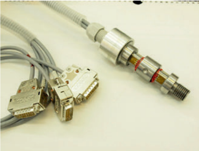
Rys. 1. Sworzeń pomiarowy z naklejonymi tensometrami Fig. 1. Measuring bolt with installed strain gauge
