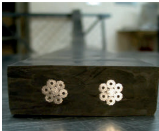
Rys. 3.a) Lina pędna typu SAG 2,5- 65 x 22/2x9 -1770, b) koncepcja prowadzenie lin pędnych z zastosowaniem pierścieni ustalających na krążniku [Gładysiewicz 2013]
