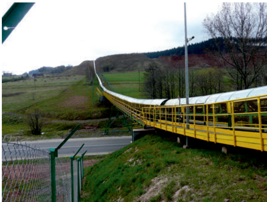
Rys. 1. Przenośnik dalekiego zasięgu transportujący kruszywo z kopalni „Świerki” do bocznicy kolejowej w Bartnicy (fot. P. Kulinowski)
