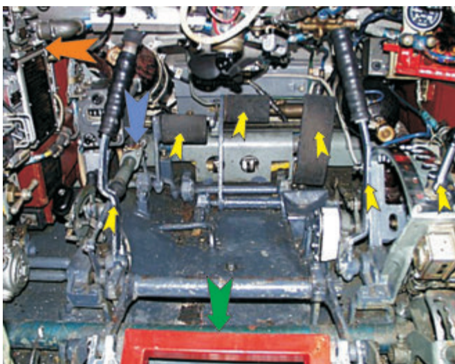
Rys.8. Widok kabiny czołgu T-72: a) z zaznaczonymi punktami mocowania elementów bloku wykonawczego układu zdalnego sterowania, b) z zamontowanymi mechanizmami bloku wykonawczego układu zdalnego sterowania: 1 - siłownik sterowania położeniem pedału sprzęgła; 2 - siłownik sterowania położeniem pedału hamulca; 3 - zmodernizowany elektromechanizm UT-6D napędzający mechanizm sterowania położeniem dźwigni zmiany prędkości obrotowej silnika; 4, 6 - mechanizmy sterowania dźwigniami skrzętu; 5 - zmodernizowany elektromechanizm UT-6D napędzający mechanizm sterowania dźwignią zmiany biegów; 7 - tablica przyrządów kontrolno-pomiarowych; 8 - zawór pneumatyczny; 9 - specjalna rama wsuwana w miejsce siedziska mechanika-kierowcy
