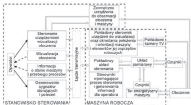
Rys. 4. Schemat funkcjonalny sterowania maszynami inżynierskimi w układzie teleoperatora
