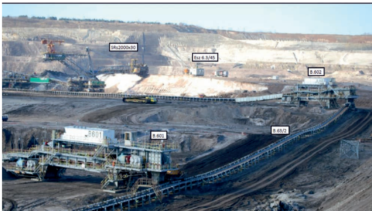
Rys. 2. Pole Belchatów. Układ technologiczny na poziomie VI w rejonie urabiania skał Fig. 2. Belchatów Field. Technological scheme on level VI in region of rock extraction
