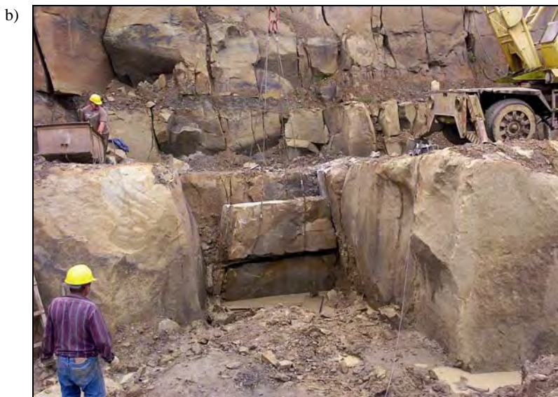
Rys. 7.7. Pozyskiwanie bloków metodą klinowania (Sobolów): a) pobijanie klinów; b) załadunek na samochód
