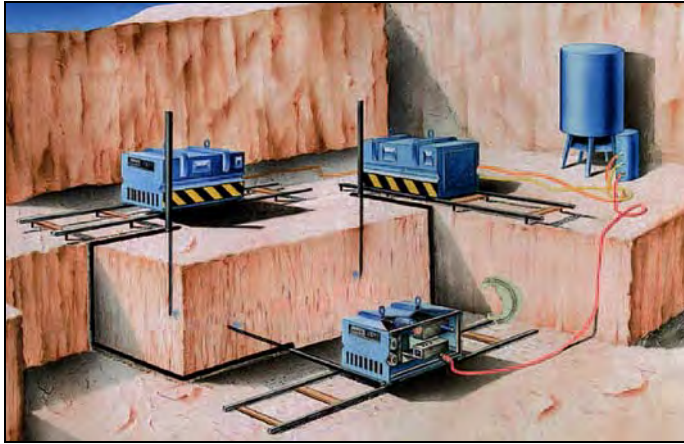
Rys. 4.48. Cięcie w złożu granitu za pomocą wysokociśnieniowej strugi wody – idea [116]
