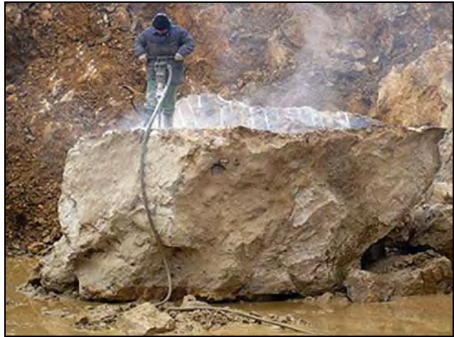
Rys. 4.31. Wiercenie w bloku marmuru za pomocą wiertarki WUP-22 [96]
