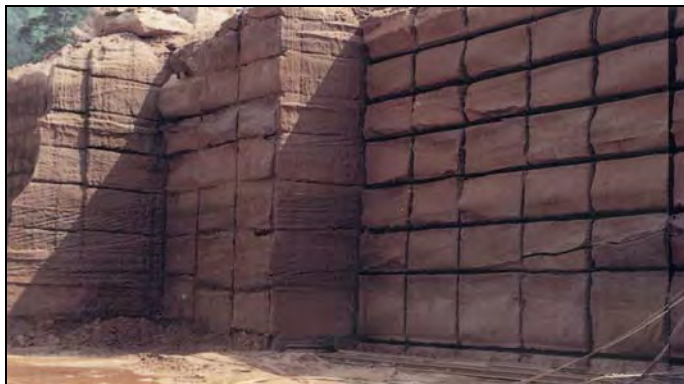
Rys. 4.49. Cięcie w złożu piaskowca za pomocą wysokociśnieniowej strugi wody [60]
