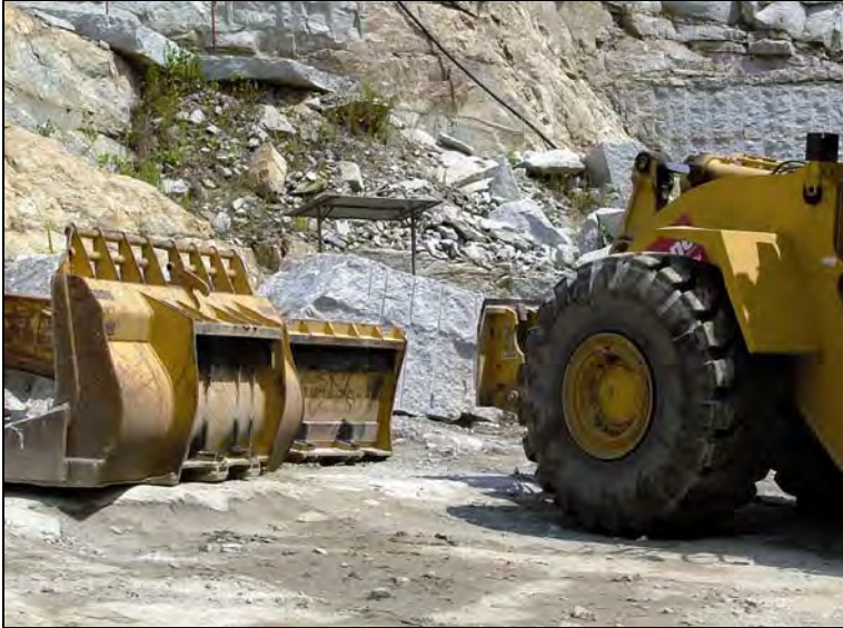
Rys. 4.56. Szybka wymiana osprzętu ładowarki dzięki szybkozłączu
