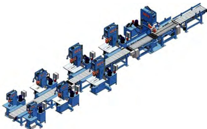
Rys. 6.11. Przykład linii produkcyjnej kostki [75]
