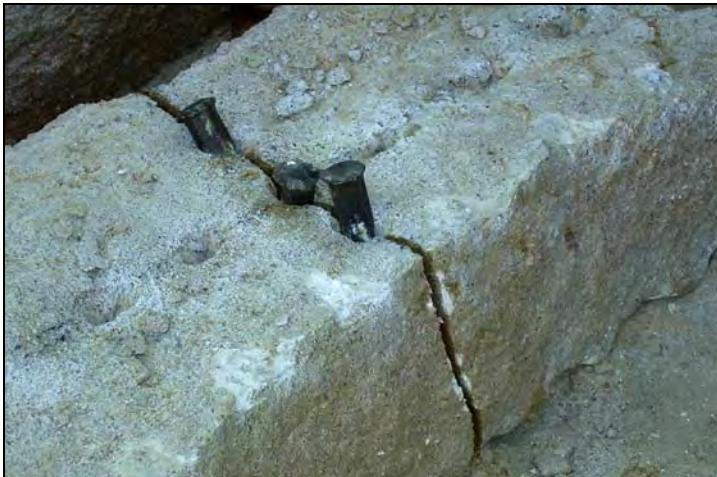
Rys. 4.47. Podział bloku na formaki za pomocą klinów tępych – piaskowiec
