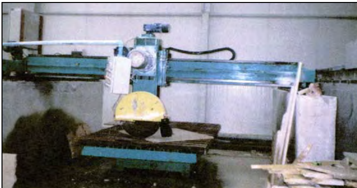
Rys. 6.16. Frezarka mostowa suportowa
