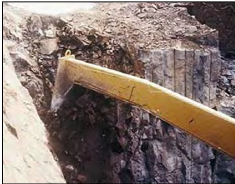
Rys. 4.55. Ładowarka z osprzętem typu łapa [95]
