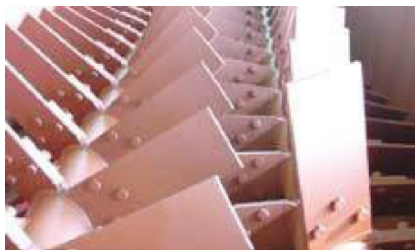
Fot. 57 Rozmieszczenie łopat w płuczce mieczowej firmy Metso (źródło www.metso.com)
