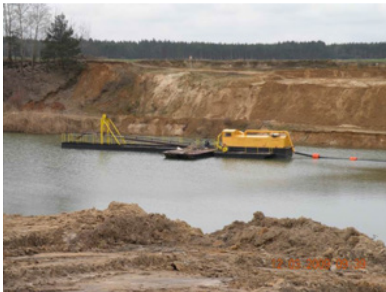
Fot. 11 Koparka ssąca (źródło: Z. Mykietiuik 12.03.2009)
