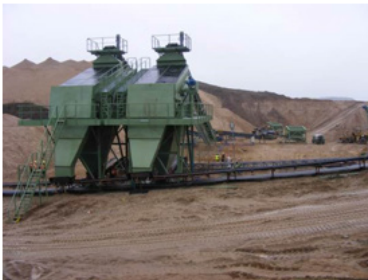
Fot. 1 Układ przeróbczy w wyrobisku kopalni piasków i żwirów (źródło: A. Witt 4.11.2007)
