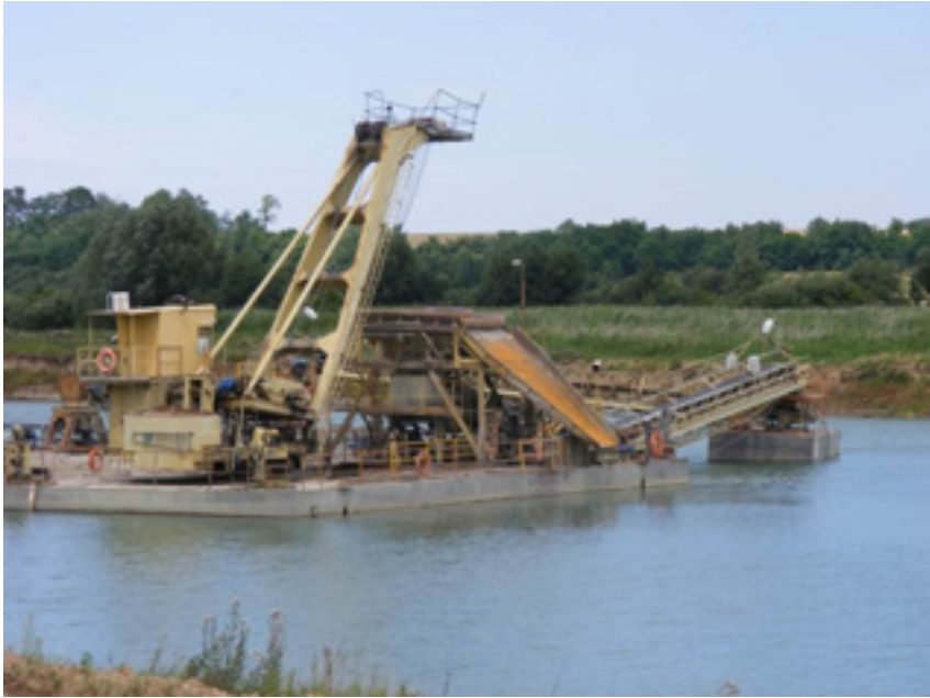
Fot. 10 Pływająca koparka chwytakowa z bocznym zrzutem ziaren nadgabarytowych (źródło: A. Witt 12.08.2010).
