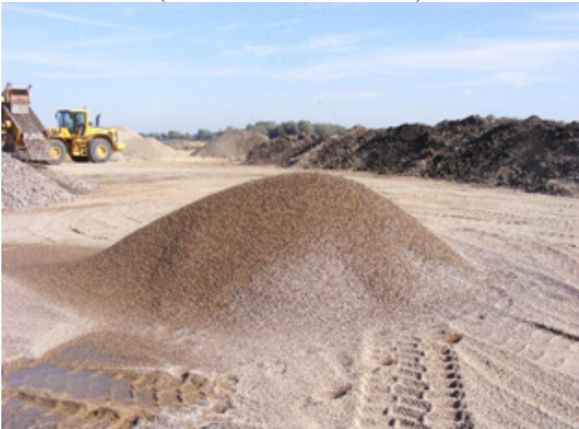
Fot. 94 Zasobnik żwiru frakcji 2 - 8 mm – widok boczny (źródło: Z. Schmidt 01.10.2012)
