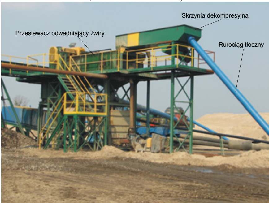
Fot. 88 Przesiewacz ze skrzynią dekompresyjną przyjmującą zawieszinę z koparki ssącej. Wariant II (źródło: Z. Schmidt 2007)
