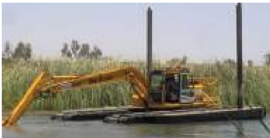
Fot. 30 Koparka łyżkowa z osprzętem podsiębiernym wyposażona w pontony oraz urządzenia do stabilizacji pozycji w trakcie urabiania złoża (źródło: www.remu.fi)
