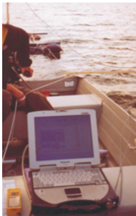
Fot. 85 Komputer rejestrujący sygnały georadaru na łodzi (źródło: A. Szynkiewicz 2010)
