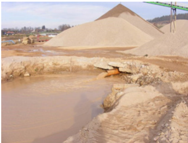
Fot. 62 Zrzut wody z zakładu przeróbczego piasków i żwirów (źródło: A. Witt 02.12.2011)
