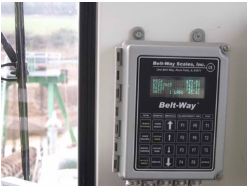
Fot. 25 Wyświetlacz podający aktualne parametry pracy koparki (źródło: A. Witt 02.12.2011)
