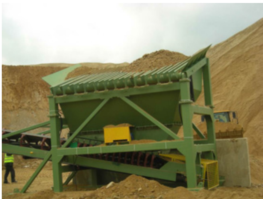
Fot. 3 Ruszt, na którym oddzielane są ziarna nadgabarytowe powyżej 150 mm (źródło: A. Witt 4.11.2007)
