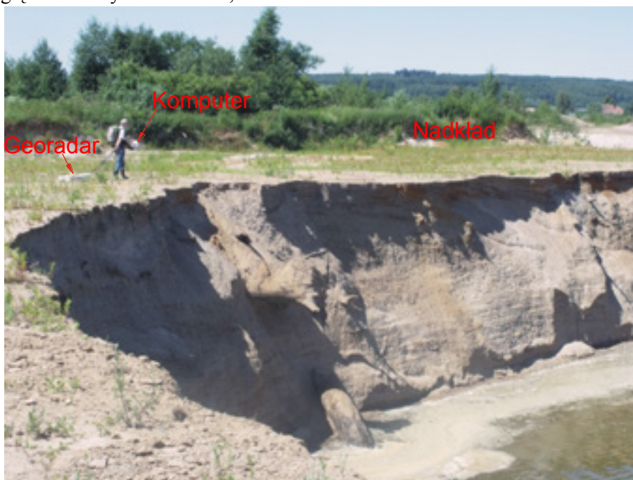
Fot. 82 Pomiar georadarem na przedpolu zabierki urabianej przez koparkę KS 160 (źródło: A. Witt 20.07.2011)
