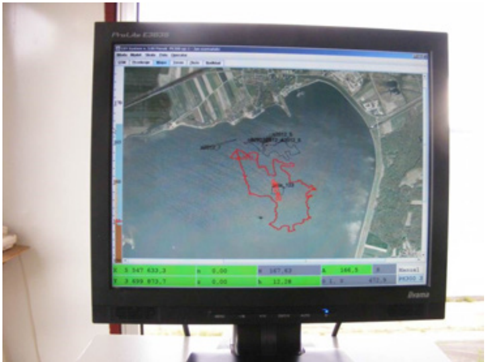
Fot. 26 Monitor przedstawiający lokalizację koparki w złożu (źródło: A. Witt 04.06.2012)
