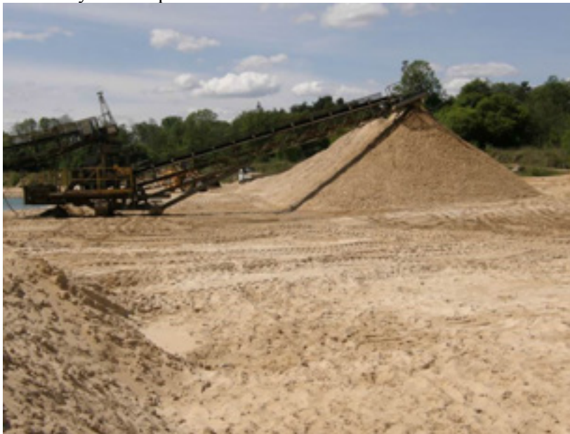
Fot. 41 Urobek wydobyty przez pływającą koparkę chwytakową składowany na brzegu wyrobiska przenośnikiem taśmowym (źródło: A. Witt 14.05.2009)
