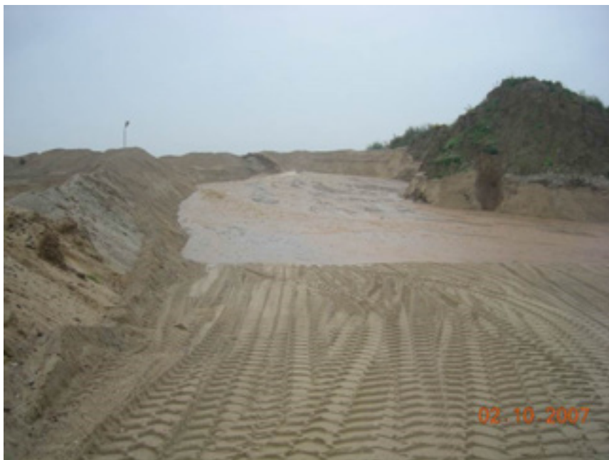
Fot. 39 Odwodnienie kopaliny w sposób naturalny (ociekowy) (źródło: A. Witt 07.10.2007)
