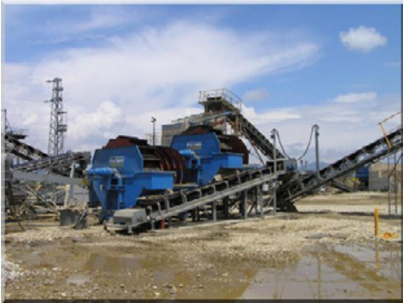
Fot. 46 Odwaniacz kołowy firmy ProSand (źródło: www.refulery.eu/ )
