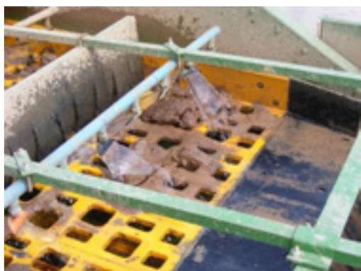
Fot. 52 Przesiewanie na pogłębiarce piasku i żwiru zaglinionego (źródło: Z. Schmidt 02.12.2011)
