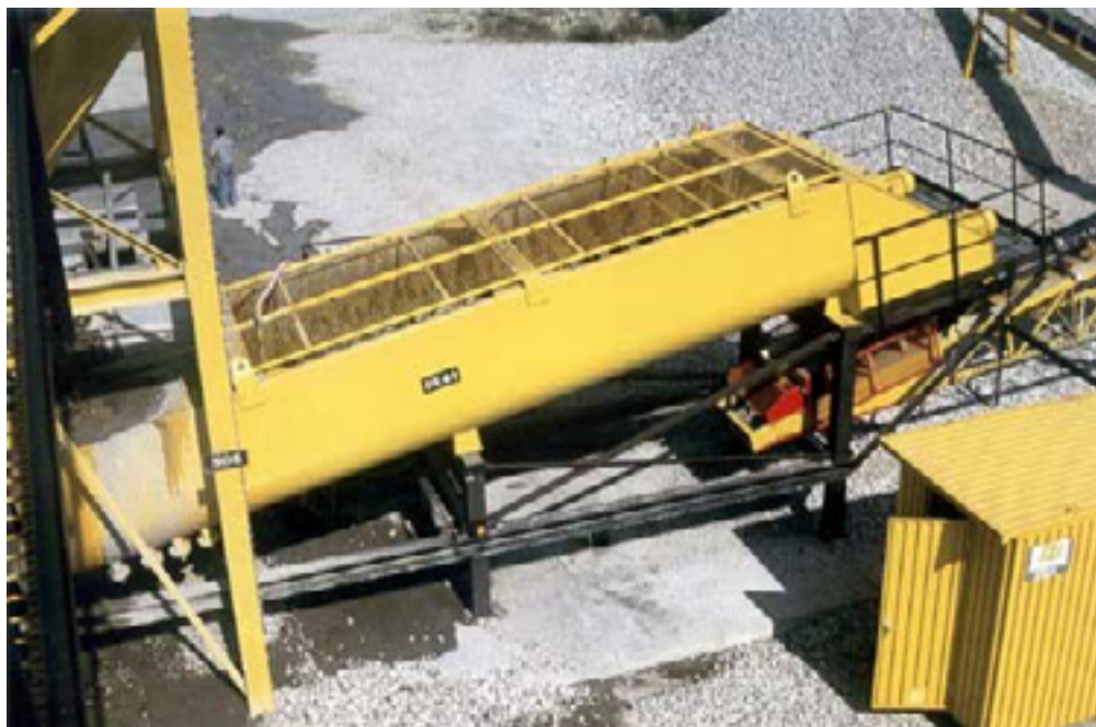
Fot. 58 Dwuwałowa płuczka mieczowa firmy MAB do płukania zanieczyszczonych żwirów i piasków (źródło: www.metso.com )
