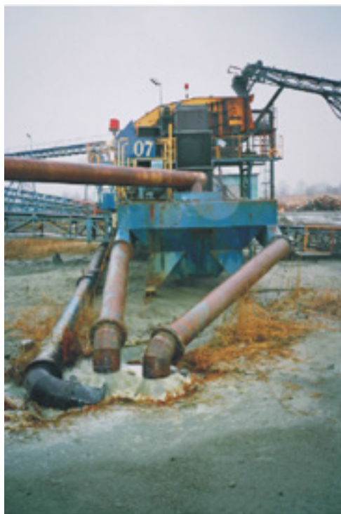
Fot. 90 Burzliwe przelewy z obu odwadniaczy - ucieczka piasków do osadnika Wariant III (źródło: Z. Schmidt 2007)
