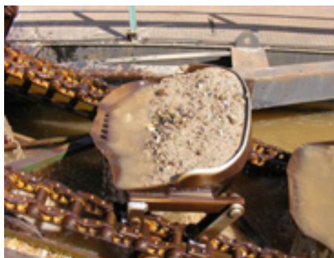
Fot. 51 Czerpak koparki wypełnionej piaskiem i żwirem z małą zawartością cząstek gliniastych (źródło: A. Witt 25.08.2010)
