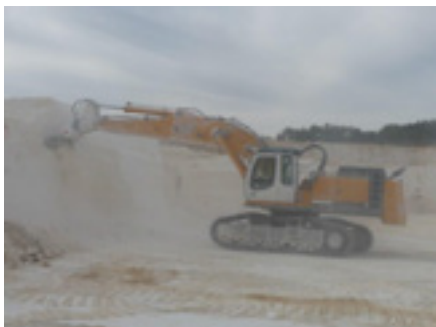
Fot. 11. Koparka z głowicą urabiającą Erkat (firma Erkat, 25.02.2013 r.)
