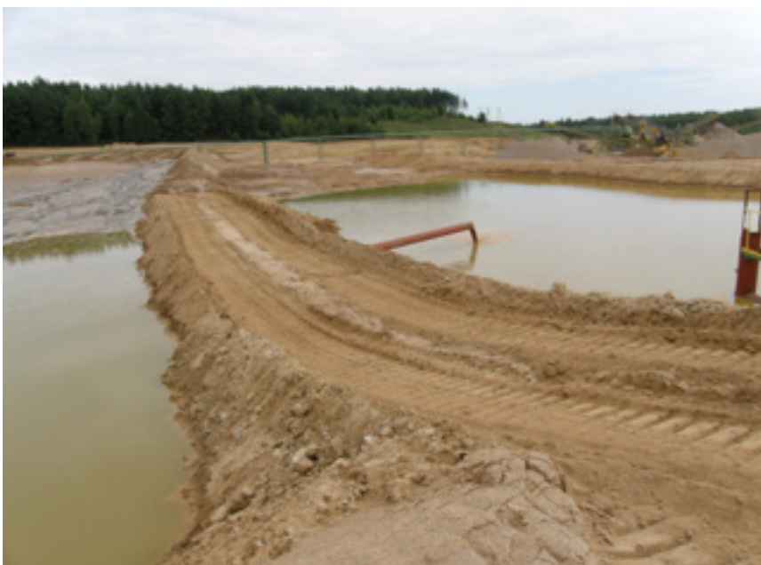
Fot. 2. Osadniki sedymentacyjne z kopalni piasków i żwirów eksploatującej złoża w części nadwodnej (A. Witt, 31.07.2008)
