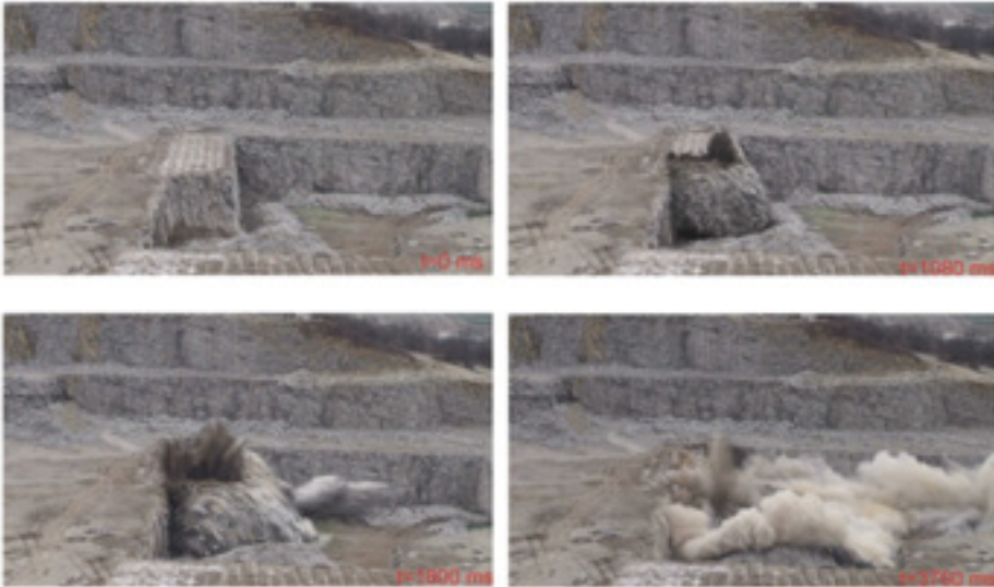
Fot. 23. Przebieg odstrzału w kopalni „Graniczna” (S. Patla, 2012)
