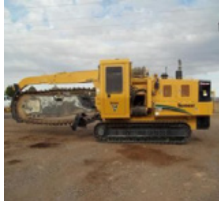
Fot. 18. Kombajn do urabiania skał firmy Vermeer ( www.bhruda.pl/Vermeer )
