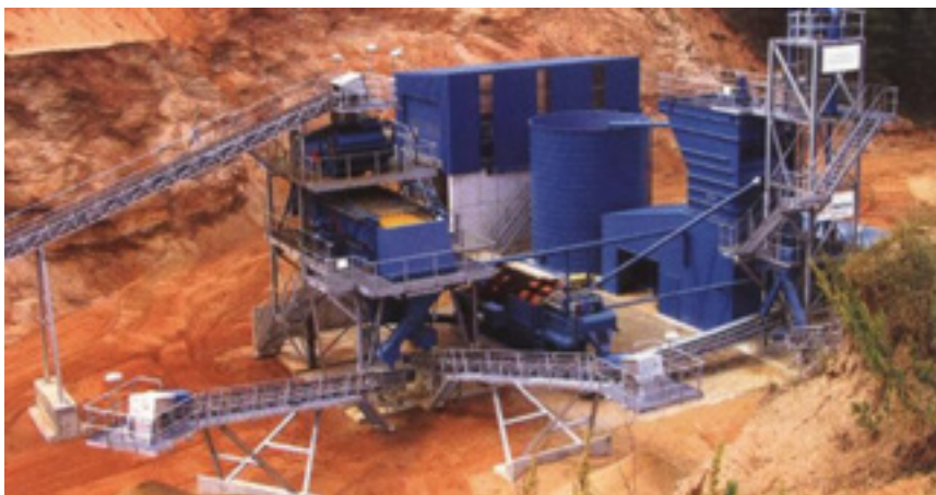
Fot. 22. Układ oczyszczania wody technologicznej w kopalni surowców skalnych
