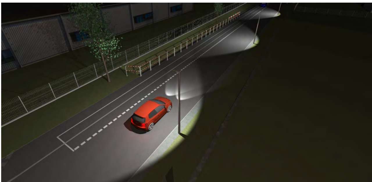
Rys. 4.10 a Przykład wzbudzania lamp przy ruchu pojazdów
