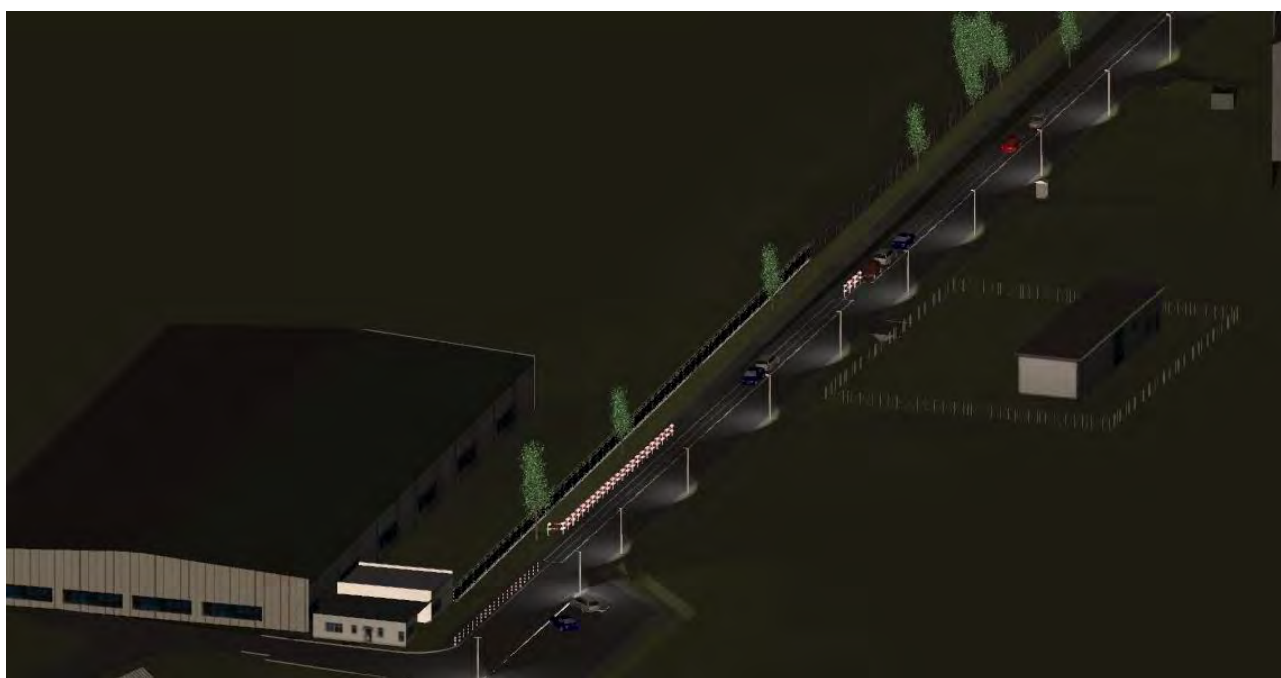
Rys.11 a Przykład przygaszenia lamp, gdy brak użytkowników
