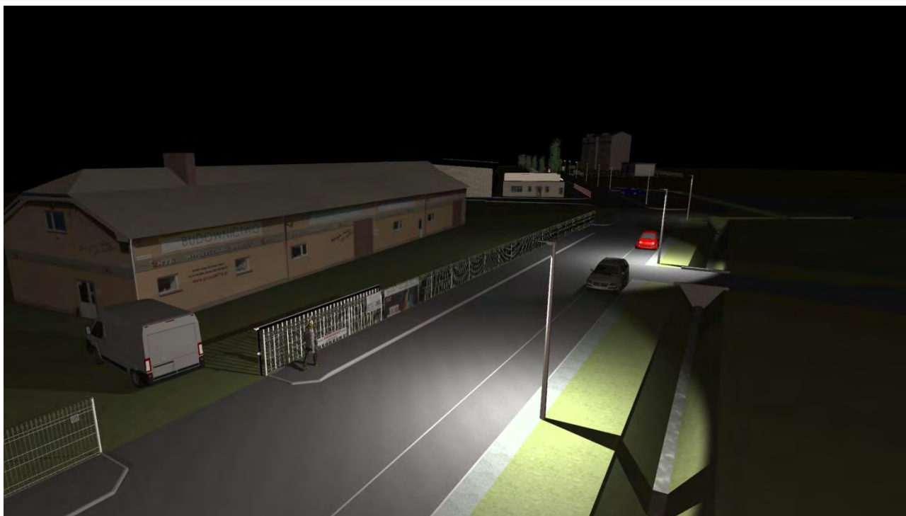
Rys. 4.9 b Przykład wzbudzania lamp w momencie wykrycia pieszego
