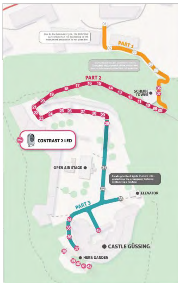
Koncepcja oświetlenia ścieżki prowadzącej do zamku z uwzględnieniem punktów oświetleniowych i sekcji oświetlenia (Źródło: EEE)
