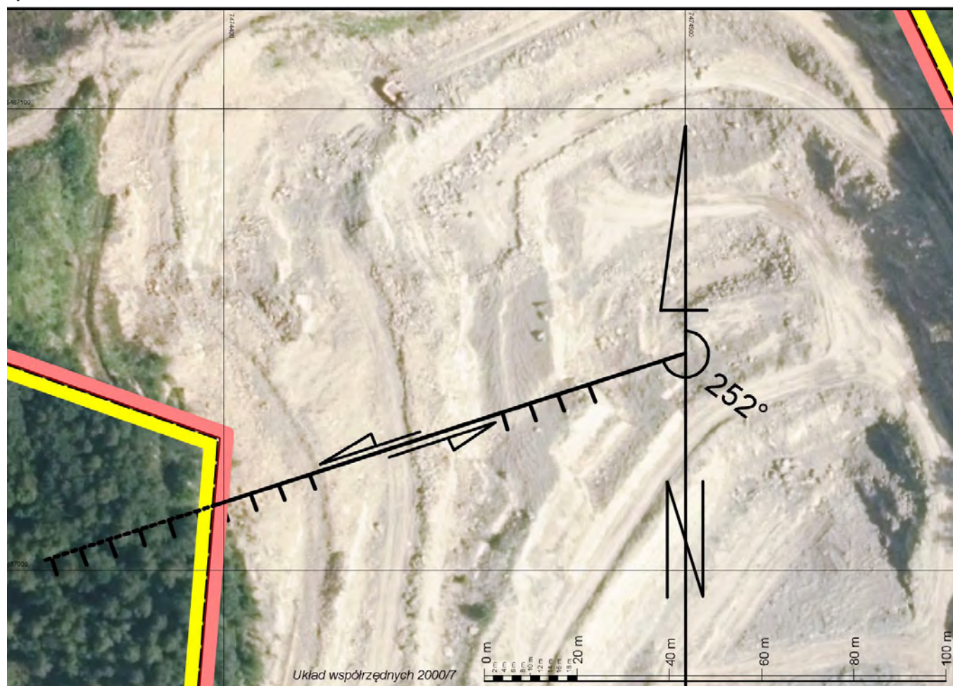
Rys. 2. Skrzydło wiszące uskoku zlokalizowane jest po stronie północnej, natomiast skrzydło zrzucone po stronie południowej Ryc. 2. The hanging wing of the fault is located on the northern side, while the downthrown wing is on the southern side
