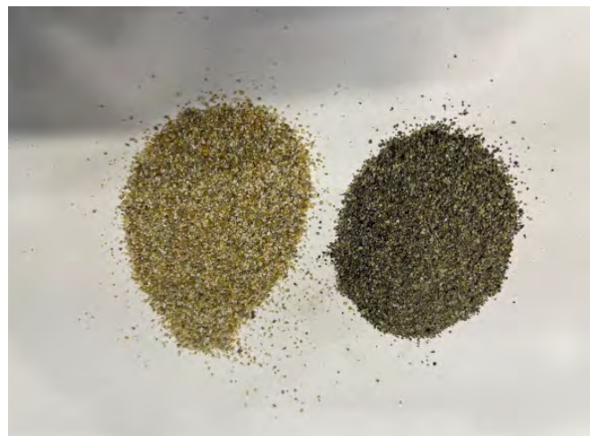
Rys. 3. Produkty separacji dla frakcji 0,5 - 1,0 mm; frakcja niemagnetyczna (lewo) i silnie magnetyczna (prawo). Źródło: [7] Becker K.H., Semeczko P. 2025
