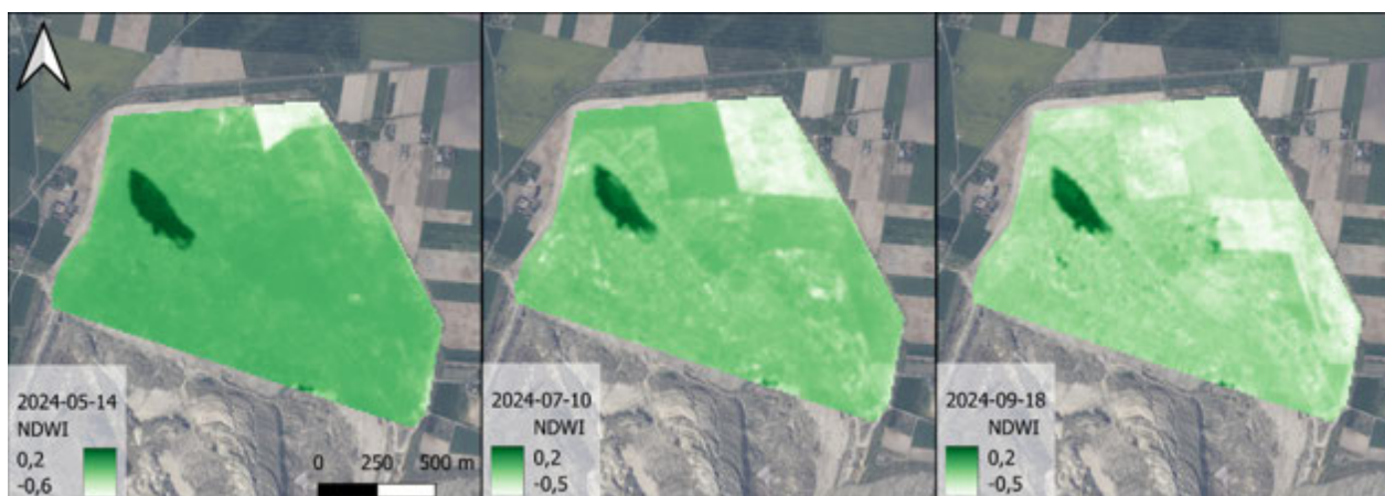
Rys. 4. Zestawienie przykładowych wyników analizy danych spektralnych w postaci wskaźnika NDWI dla trzech dat, dla obszaru zwalowiska wewnętrznego Fig. 4. Summary of the exemplary results of the analysis of spectral data in the form of the NDWI index for three dates, for the area of the internal dumping ground
