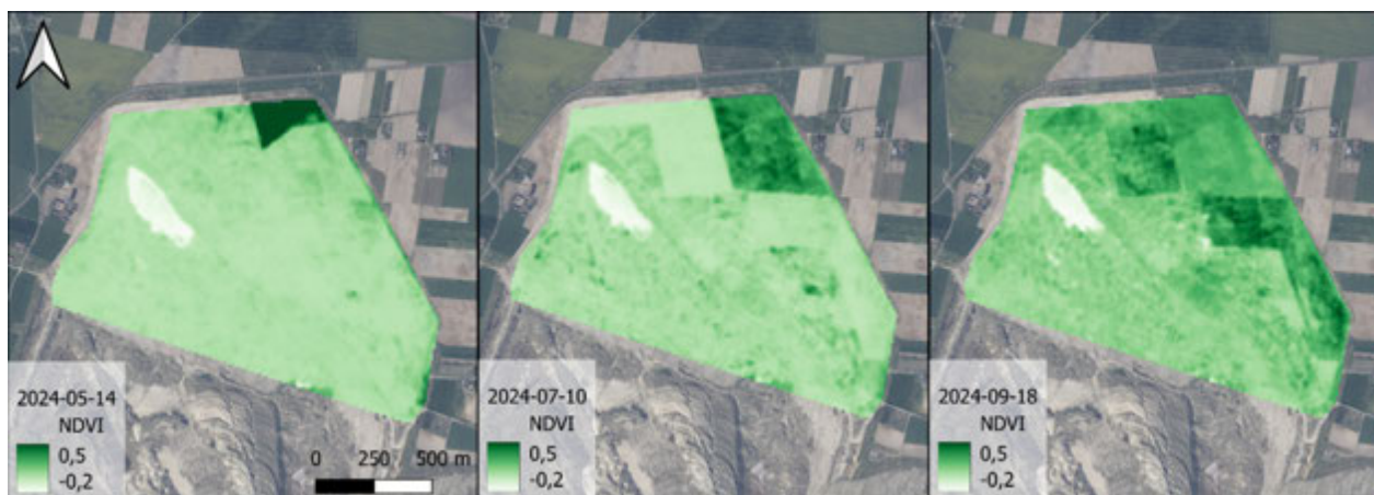
Rys. 3. Zestawienie przykładowych wyników analizy danych spektralnych w postaci wskaźnika NDVI dla trzech dat, dla obszaru zwalowiska wewnętrznego Fig. 3. Summary of the exemplary results of the analysis of spectral data in the form of the NDVI index for three dates, for the area of the internal dumping ground
