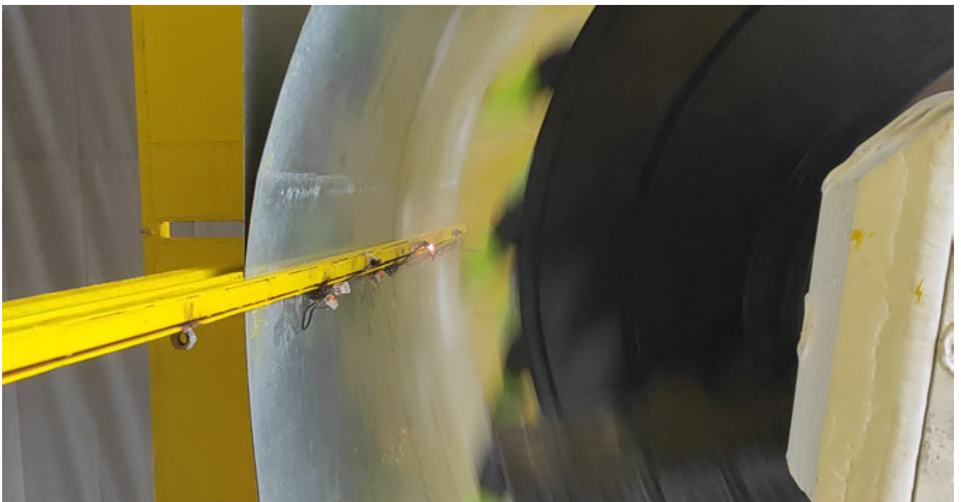
Rys. 8. Próba wywołania zapłonu w czasie działania instalacji
