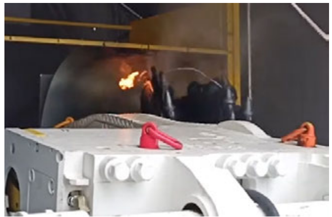
Rys. 5. Próba gaszenia występującego zapłonu gazu: a) moment przed uruchomieniem instalacji, b) moment rozpoczęcia działania instalacji
