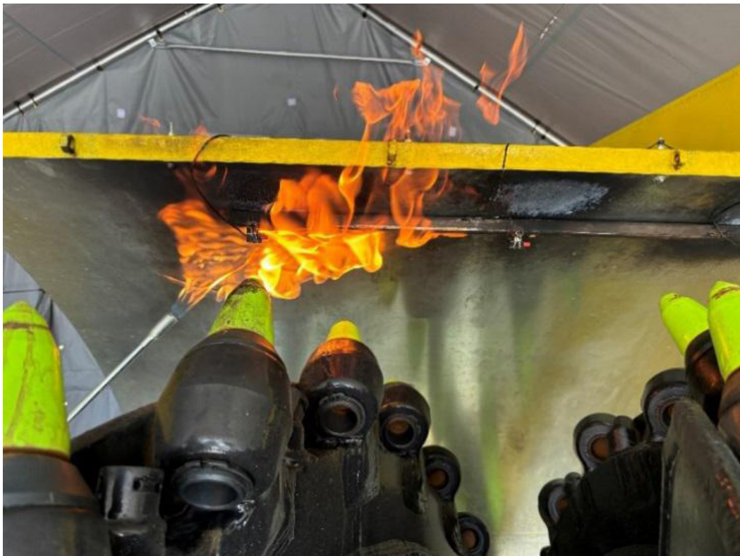
Rys. 6. Proces zapłonu gazu przed próbą gaszenia
