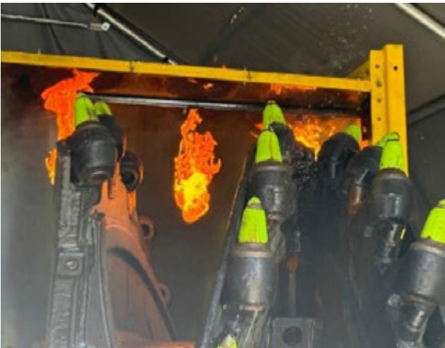
Rys. 5. Próba gaszenia występującego zapłonu gazu: a) moment przed uruchomieniem instalacji, b) moment rozpoczęcia działania instalacji
