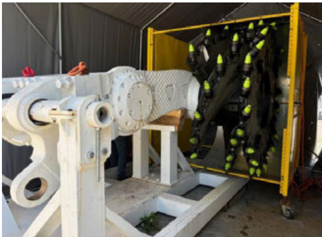
Rys. 2. Modułowe stanowisko do badania skuteczności gaszenia metanu przez kombajny górnicze: a) konfiguracja dostosowana do badań kombajnów ścianowych; b) położenie palników [6]
