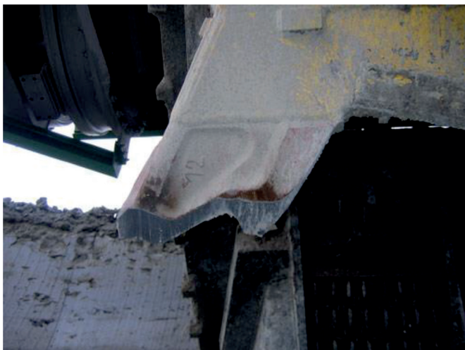
Rys. 10. Zużycie naroży czerpaków CK910-N3 – po ok. 136 h pracy w warunkach trudno urabialnych
