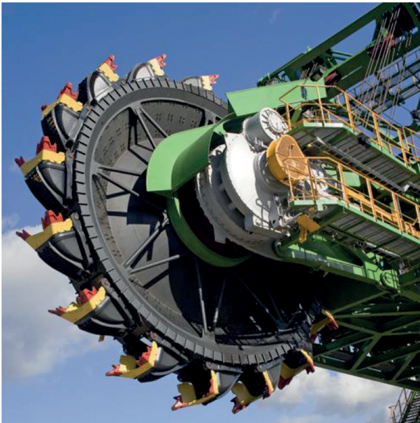
Rys. 7. Układ urabiania z zespołem napędowym 2x500 kW Fig. 7. Mining system with 2x 500 kW power unit
