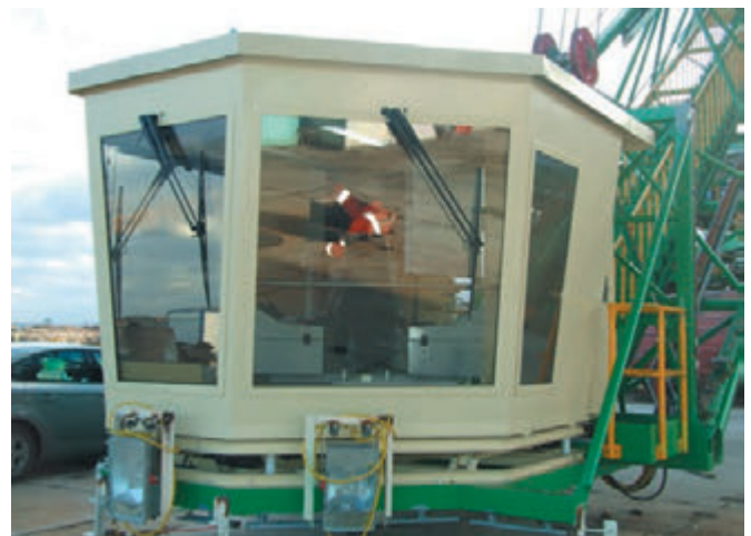
Rys. 1. Kabina operatora koparki KWK 1500.1–K18 dla PGE GiEK Oddział KWB Turów
