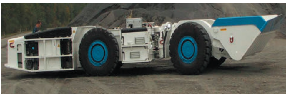
Rys. 1. Widok ogólny ładowarki GHH SLP8H podczas testów naziemnych
